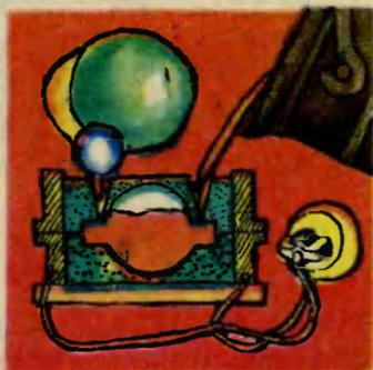
процесс... в электрическом поле, пропуская через слиток слабый ток. В этом случае, как показали исследования и эксперименты, поверхностное натяжение расплавленного металла немного уменьшается. Но этого, оказы-
